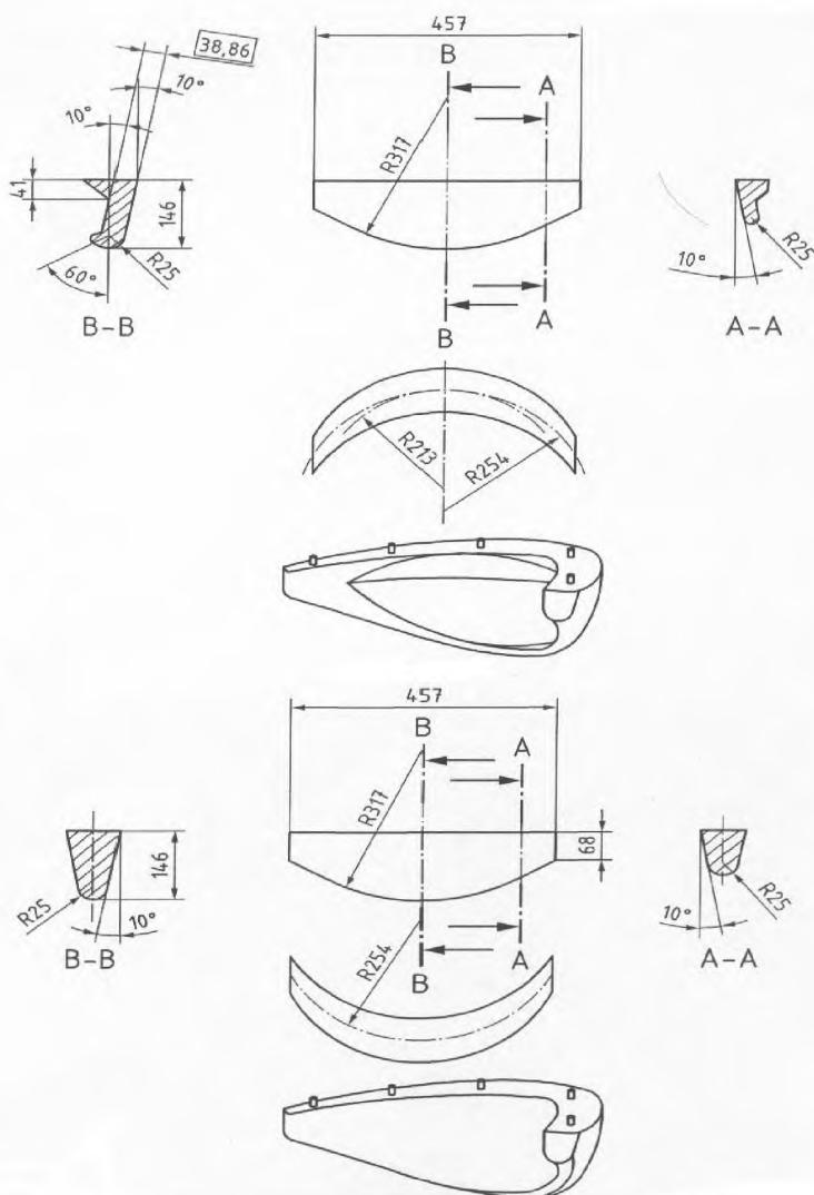
Примечание – Размеры приведены в миллиметрах; материал изделий: AlSi2MgTi или AlSi7Mg0,3 (см. [2]); маркировка: TF (см. [1]); шероховатость обработки поверхности Ra 1,25 мкм.
