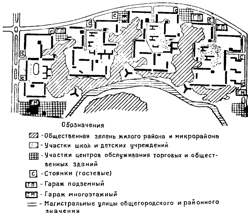
Рис. 2. Схема размещения стоянок и гаражей в жилом районе
