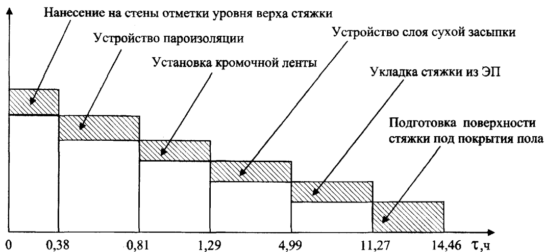
Рис. 6.6. График движения рабочей силы при устройстве сборного основания типа «Вега» по выравнивающему тепло-звукоизоляционному слою сухой засыпки толщиной 40 мм со стяжкой из элементов пола (к табл. 6.6)
