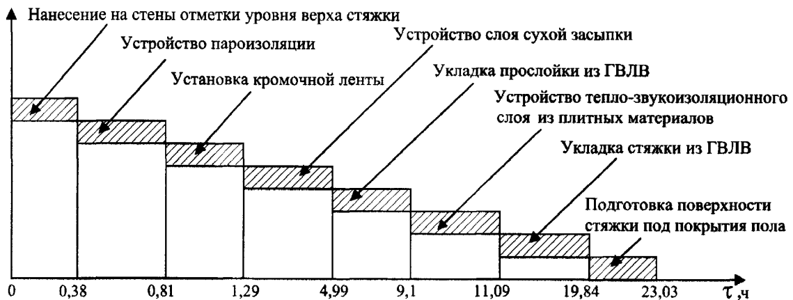
Рис. 6.7.1 а. График движения рабочей силы при устройстве сборного основания типа «Гамма» по выравнивающему тепло-звукоизоляционному слою сухой засыпки толщиной 40 мм с прослойкой из ГВЛВ на тепло-звукоизоляционном слое из плитных материалов со стяжкой из ГВЛВ (к табл. 6.7.1)
