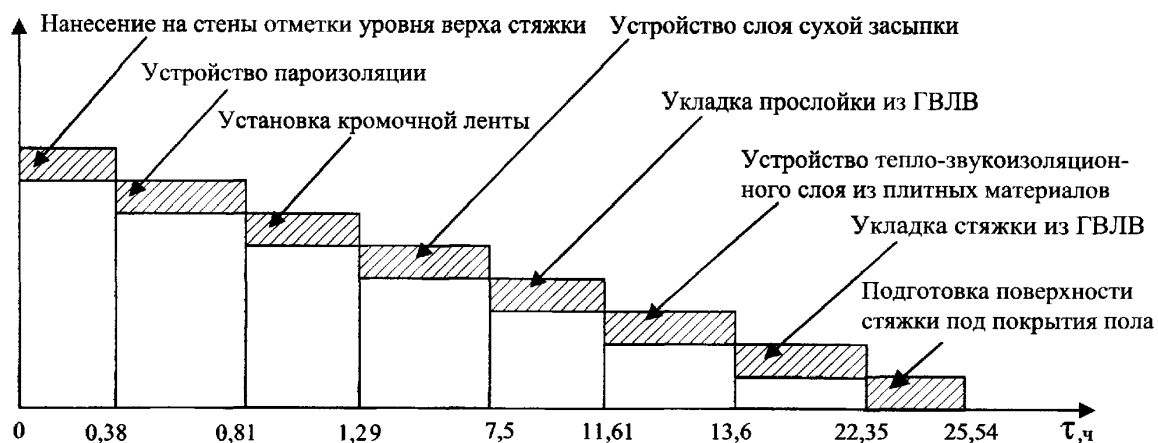
Рис. 6.10.1 а. График движения рабочей силы при устройстве сборного основания типа «Гамма» по выравнивающему тепло-звукоизоляционному слою сухой засыпки толщиной 100 мм с прослойкой из ГВЛВ на тепло-звукоизоляционном слое из плитных материалов со стяжкой из ГВЛВ (к табл. 6.10.1)
