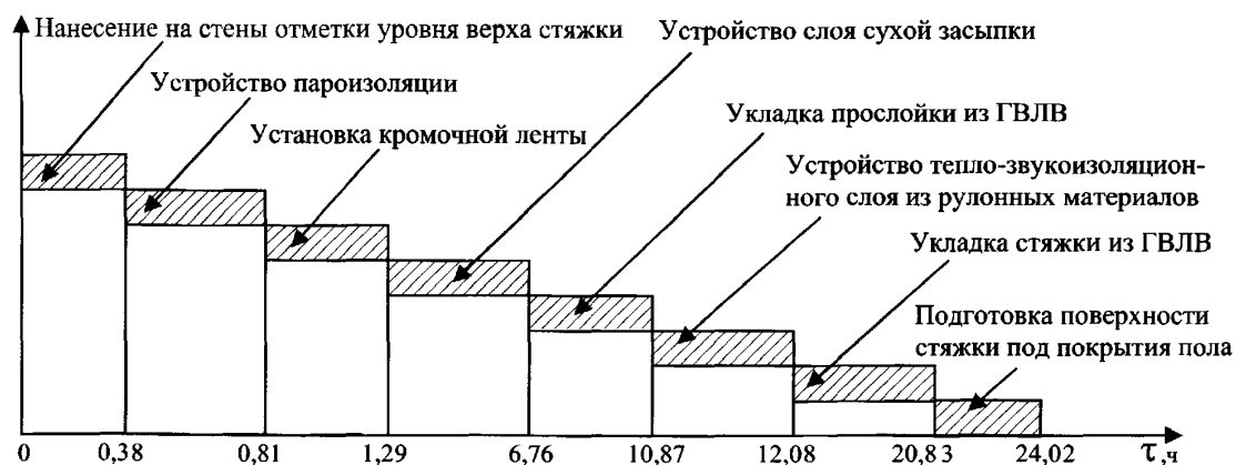
Рис. 6.9.2 а. График движения рабочей силы при устройстве сборного основания типа «Гамма» по выравнивающему тепло-звукоизоляционному слою сухой засыпки толщиной 80 мм с прослойкой из ГВЛВ на тепло-звукоизоляционном слое из рулонных материалов со стяжкой из ГВЛВ (к табл. 6.9.2)
