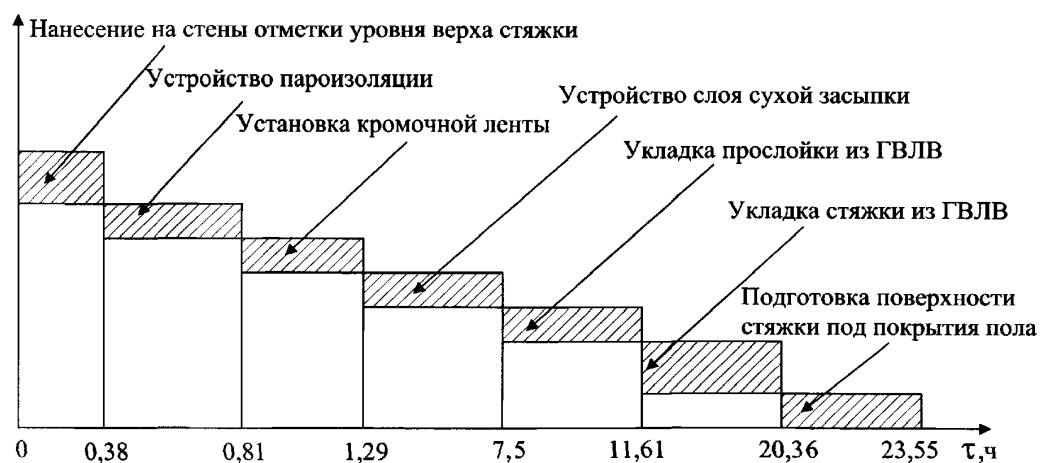
Рис. 6.9 а. График движения рабочей силы при устройстве сборного основания типа «Вега» по выравнивающему тепло-звукоизоляционному слою сухой засыпки толщиной 100 мм со стяжкой из гипсоволокнистых листов влагостойких (к табл. 6.9)
