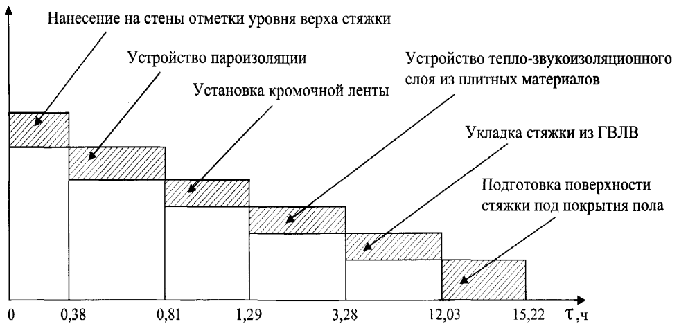
Рис. 6.3.1 а. График движения рабочей силы при устройстве сборного основания типа «Бета» на тепло-звукоизоляционном слое из плитных материалов со стяжкой из малоформатных ГВЛВ (к табл. 6.3.1)
