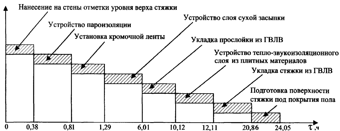
Рис. 6.8.1 а. График движения рабочей силы при устройстве сборного основания типа «Гамма» по выравнивающему тепло-звукоизоляционному слою сухой засыпки толщиной 60 мм с прослойкой из ГВЛБ на тепло-звукоизоляционном слое из плитных материалов со стяжкой из ГВЛБ (к табл. 6.8.1)
