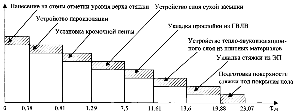
Рис. 6.10.1. График движения рабочей силы при устройстве сборного основания типа «Гамма» по выравнивающему тепло-звукоизоляционному слою сухой засыпки толщиной 100 мм с прослойкой из ГВЛВ на тепло-звукоизоляционном слое из плитных материалов со стяжкой из элементов пола (к табл. 6.10.1)
