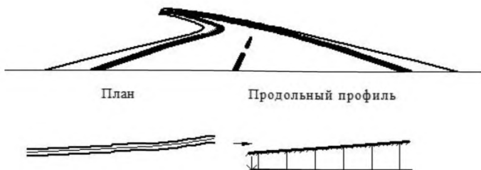
Рис. 13.5. Нарушение зрительной плавности дороги на участке с малым углом поворота в плане.
