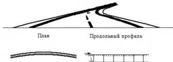
Рис. 13.7 Нарушение зрительной плавности дороги прямой вставкой в
