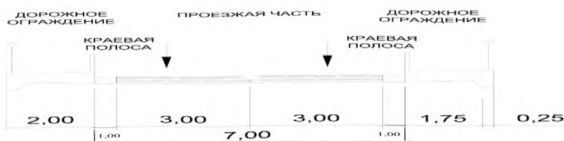
Рис14.33. Поперечный профиль на мостах для дорог IV категории
