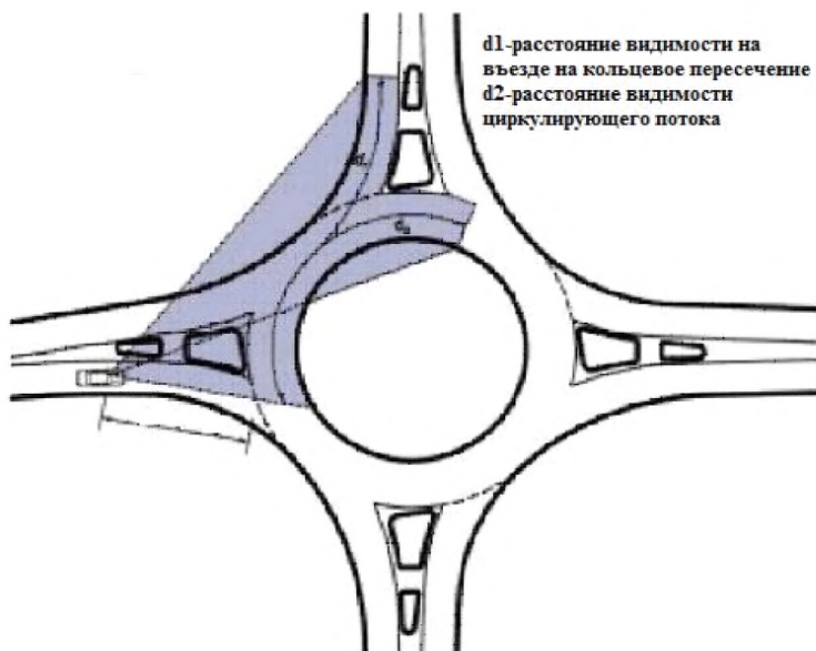
Рис. 15.6 Схема для расчета минимального расстояния видимости на въезде на кольцевое пересечение и участке циркулирующего потока.
