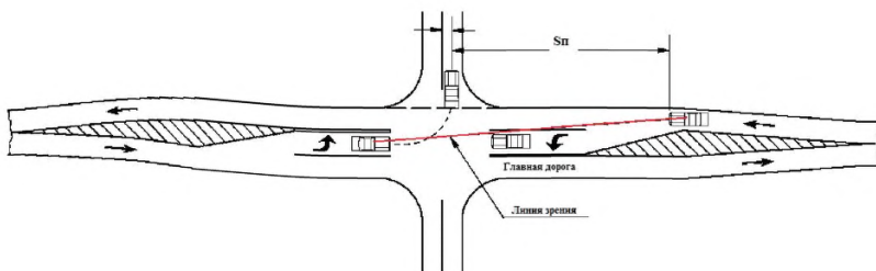
Рис. 15.4 Схема для расчета Минимального расчетного расстояния видимости на левоповоротном съезде с основной дороги
