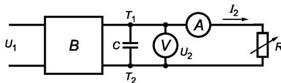
$U_1$  — напряжение питания;  $U_2$  — выходное напряжение;  $I_2$  — выходной ток;  $A$  — амперметр;  $B$  — зарядное устройство батарей;  $V$  — вольтметр;  $R$  — переменный резистор;  $T_1$  и  $T_2$  — выходные зажимы зарядного устройства батарей;  $C$  — конденсатор емкостью  $E$  в фардах, рассчитываемой по формуле
