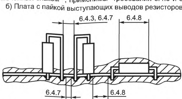
Рисунок 5 — Длина пути утечки и зазоры на печатных платах
