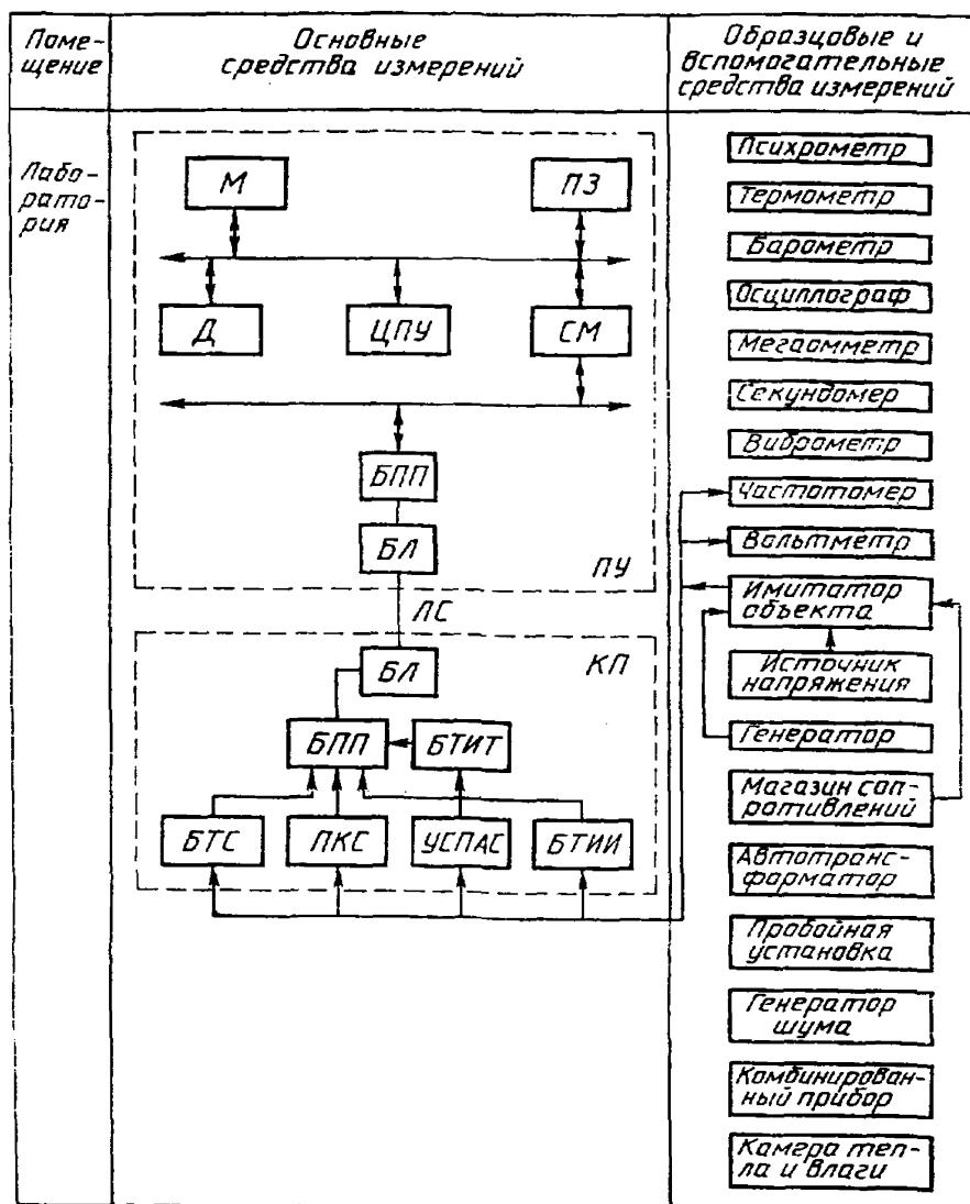
БЛ—блок линейный; БПП—блок приема-передачи; БТИТ—блок телеметрирования текущих значений параметров; БТС—блок телесигнализации; БТИИ—блок телеметрирования интегральных значений параметров; Д—дисплей; ЛС—линия связи; М—центральный процессор; ПЗ—память ОЗУ; ПКС—узел приема кодовых сигналов; СМ—согласующий модуль; УСПАС—устройство сбора и преобразования аналоговых сигналов; ЦПУ—цифропечатающее устройство
