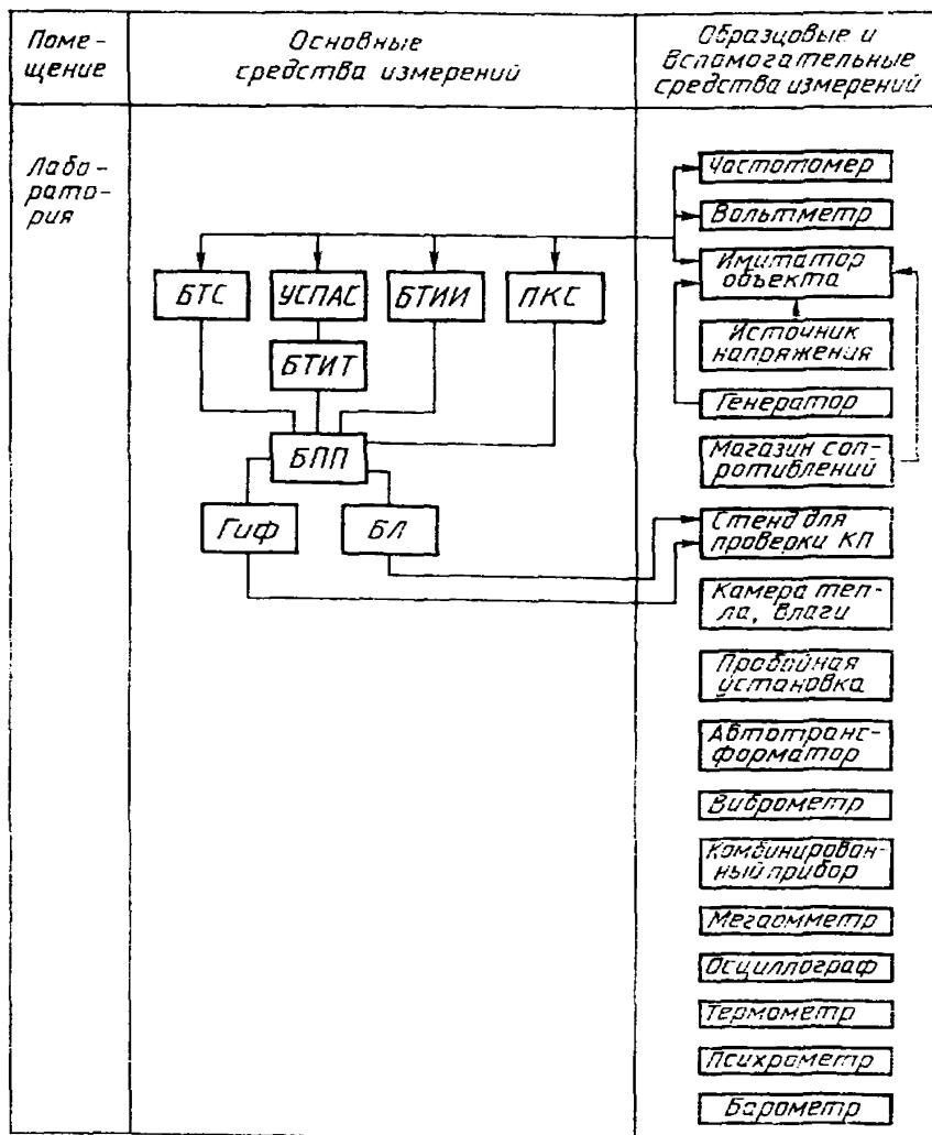
БЛ—блок линейный, БПП—блок приема-передачи, БТС—блок телесигнализации состояния объекта, БТИТ—блок телемерсения текущих значений параметров, БТИИ—блок телемерсения интегральных значений параметров, ГиФ—субблок генераторов и фильтров, ПКС—узел приема кодовых сигналов. УСПАС—устройство сбора и преобразования сигналов.
