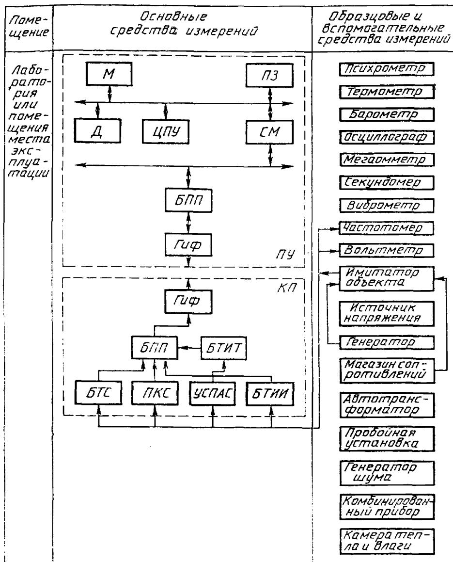
*БПП*—блок приема-передачи; *БТИТ*—блок телеметрических текущих значений параметров; *БТИИ*—блок телеметрических интегральных значений параметров; *БТС*—блок телесигнализации; *ГиФ*—субблок генераторов и фильтров; *Д*—дисплей; *ПЗ*—память ОЗУ; *ПКС*—узел приема кодовых сигналов; *СМ*—согласующий модуль; *УСПАС*—устройство сбора и преобразования аналоговых сигналов; *ЦПУ*—цифронапечатающее устройство
