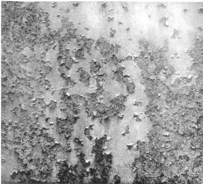
Рисунок 13 — Коррозия металла балл K5 (или R/5)
