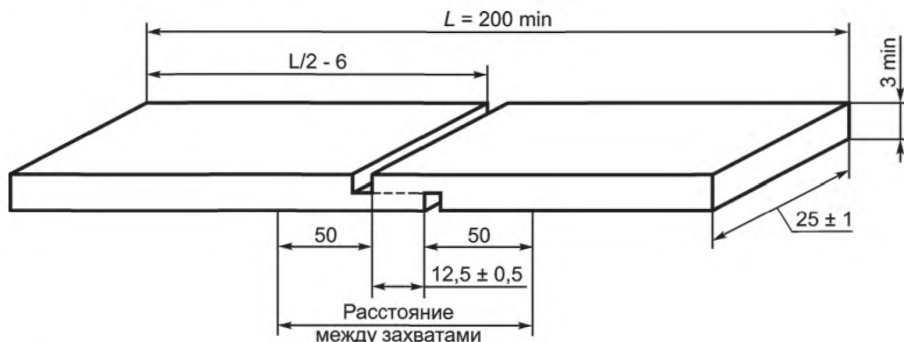
Рисунок 8.7 — Образец для испытания на прочность соединения внахлестку при сдвиге
