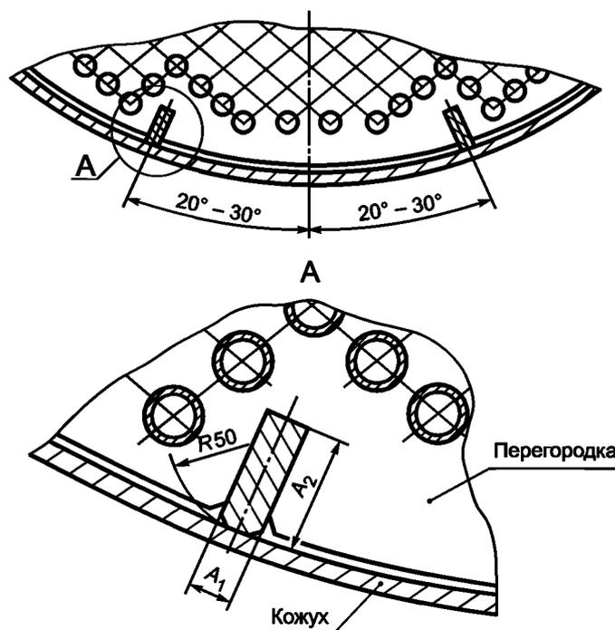
Рисунок 3 — Расположение полос скольжения в трубных пучках аппаратов
