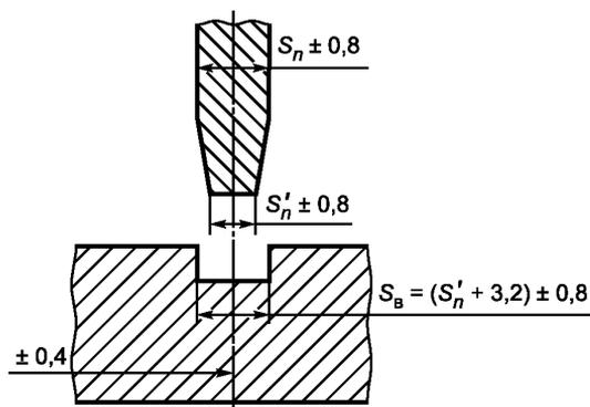
Рисунок 8 — Узел соединения перегородки с решеткой
