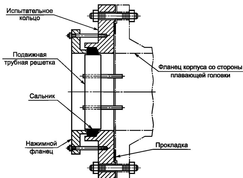
Рисунок 9 — Испытательное приспособление для аппаратов с плавающей головкой
