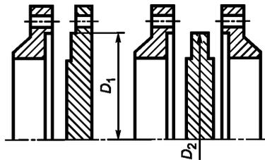
Рисунок 7 — Узлы соединения решеток и фланцев
