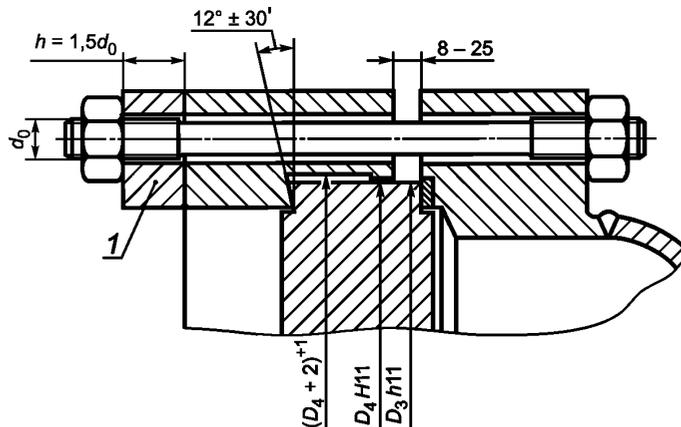
Рисунок 6 — Размеры и отклонения размеров деталей плавающей головки
