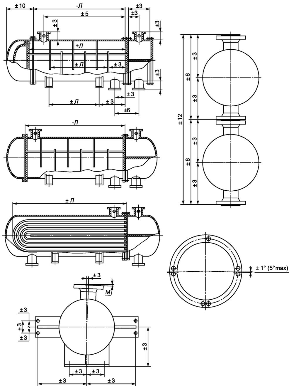
Рисунок 5 — Предельные отклонения габаритных и присоединительных размеров
