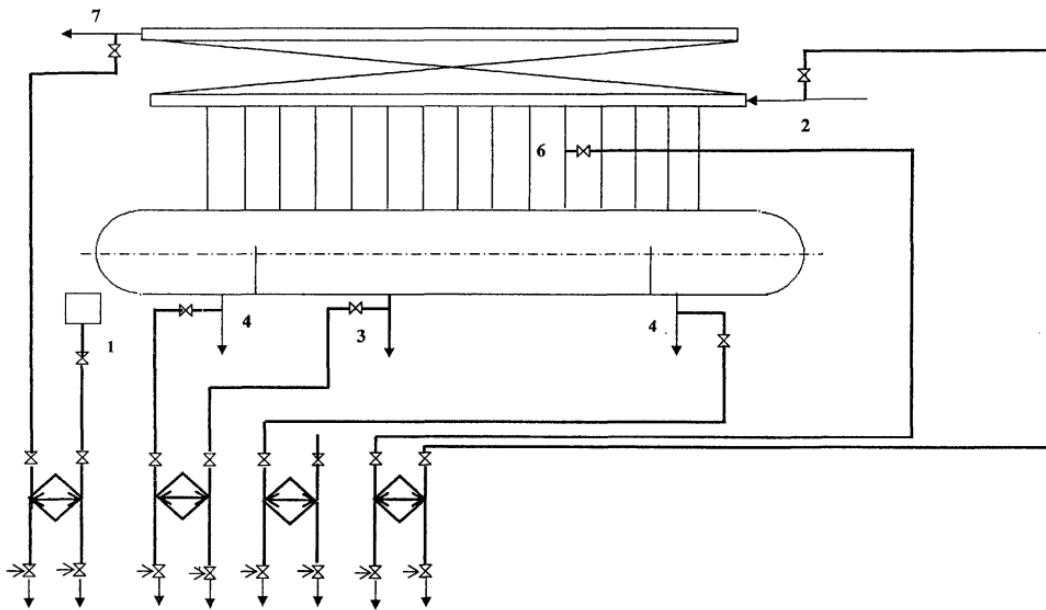
Рисунок 11-Схема отборов проб пара и воды барабанных котлов с давлением 10 МПа
