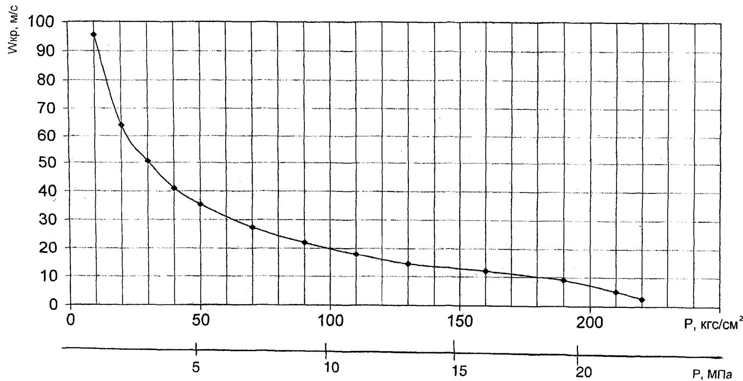
Рисунок А.1-График зависимости критической скорости срыва пленки влаги от давления
