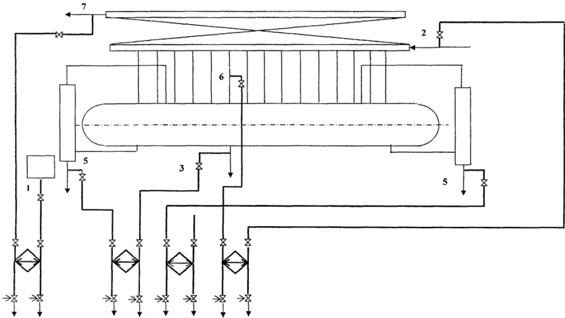
Рисунок 12- Схема отборов проб пара и воды барабанных котлов с давлением 10 МПа
