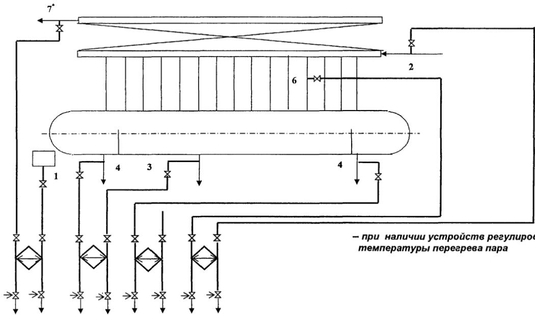
Рисунок 17- Схема отборов проб пара и воды барабанных котлов низкого и среднего давления с двухступенчатым испарением (вторая ступень испарения- внутрибарабанная)
