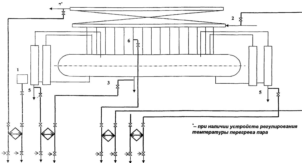
**Рисунок 20- Схема отборов проб пара и воды барабанных котлов низкого и среднего давления с трехступенчатым испарением (вторая и третья ступени испарения - выносные циклоны, соединенные последовательно и подключенные к разным панелям экранов)**
