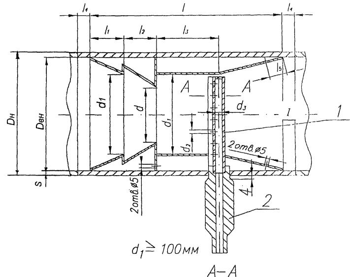
Рисунок 4-Зонд щелевой со смесителем
