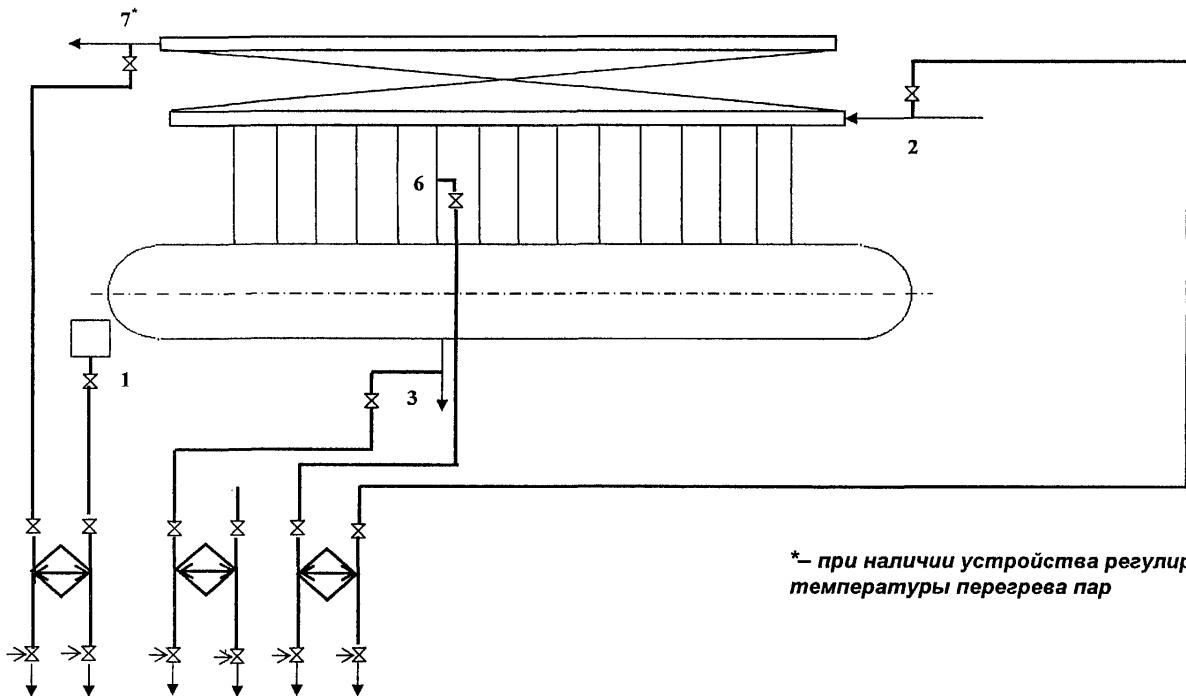
**Рисунок 16- Схема отборов проб пара и воды барабанных котлов низкого и среднего давления с одноступенчатым испарением**
