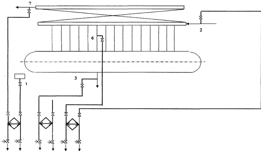
Рисунок 10- Схема отборов проб пара и воды барабанных котлов с давлением 10 МПа
