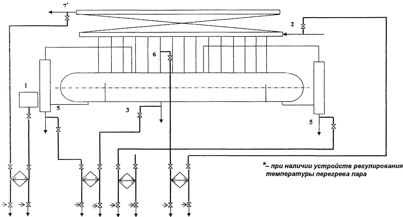
**Рисунок 19- Схема отборов проб пара и воды барабанных котлов низкого и среднего давления с трехступенчатым испарением
