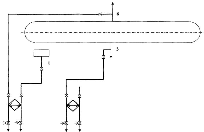
*Рисунок 15- Схема отборов проб пара и воды барабанных котлов низкого давления
