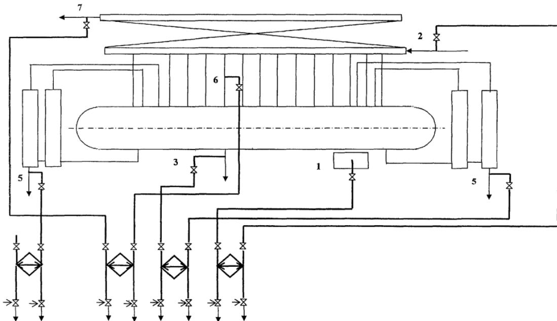
Рисунок 13- Схема отборов проб пара и воды барабанных котлов с давлением 10 МПа
