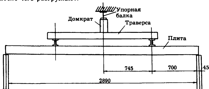
Рис. 2. Схема установки для испытания плит
