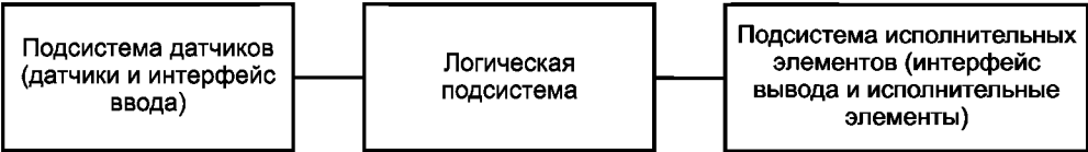
Рисунок В.3 — Структура подсистем Э/Э/ПЭ системы, связанной с безопасностью
