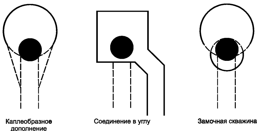
Рисунок 17 — Примеры измененных соединений проводника и контактной площадки
