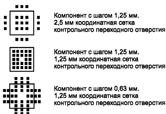
Рисунок 25 — Принципы расположения контрольных переходных отверстий по координатной сетке
