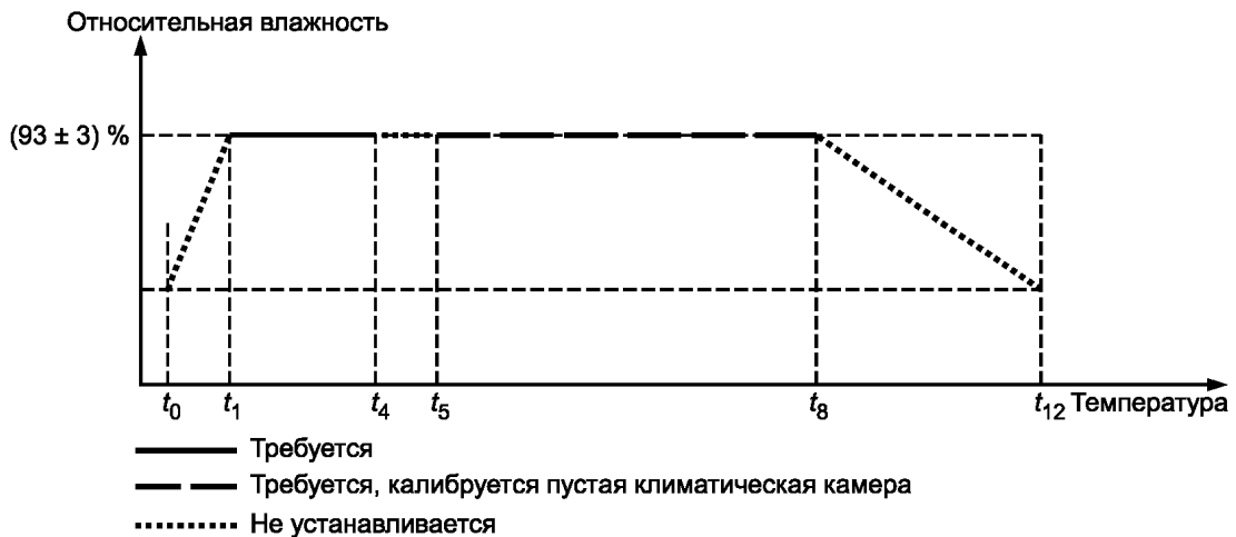
Рисунок К.4 — Относительная влажность в климатической камере в течение одного рабочего цикла
