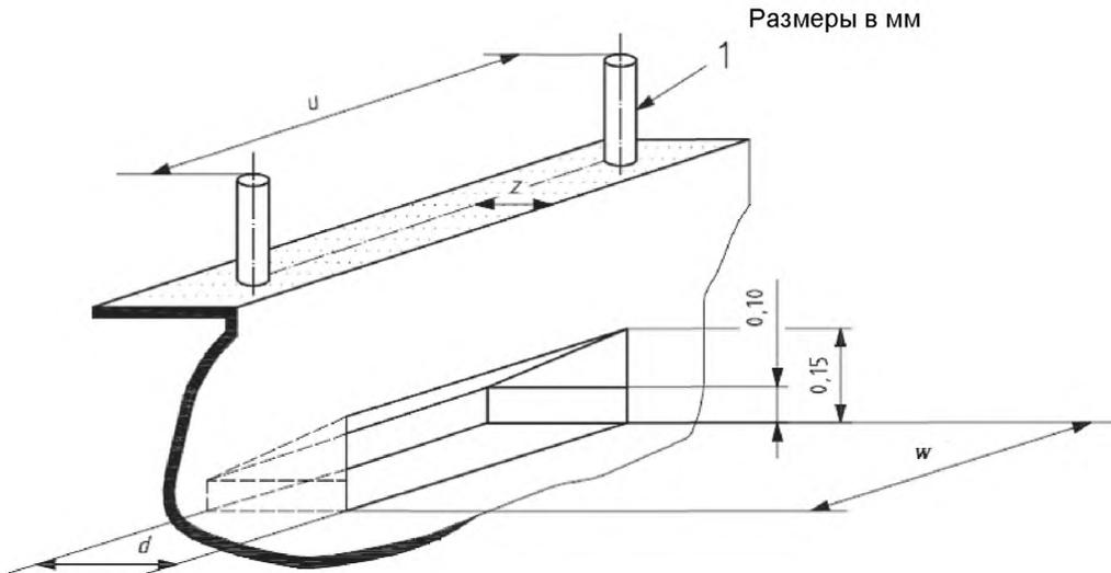
1 – поручень;  $d$  – расстояние между центральной линией ступени и вертикальной поверхностью;  $W$  – ширина ступени;  $u$  – расстояние между параллельными поручнями, между которыми должен быть обеспечен проход;  $z$  – расстояние между ступенью и поручнем/перилами
