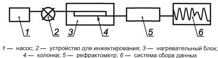
Рисунок 1 — Схема жидкостного хроматографа
