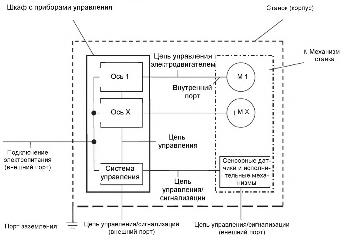
Рисунок 1 – Конфигурация системы и примеры соединений
