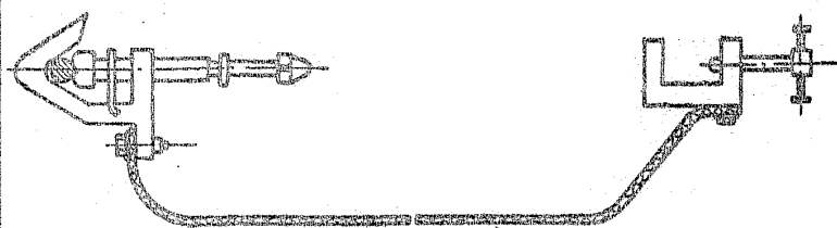
Рис. 2. Узел I. Установка переносного трехветвевое заземления. Узел II. Закрепление струбцины заземления на поясной ушке опоры. Узел III. Установка переносного одноветвевое заземления.
