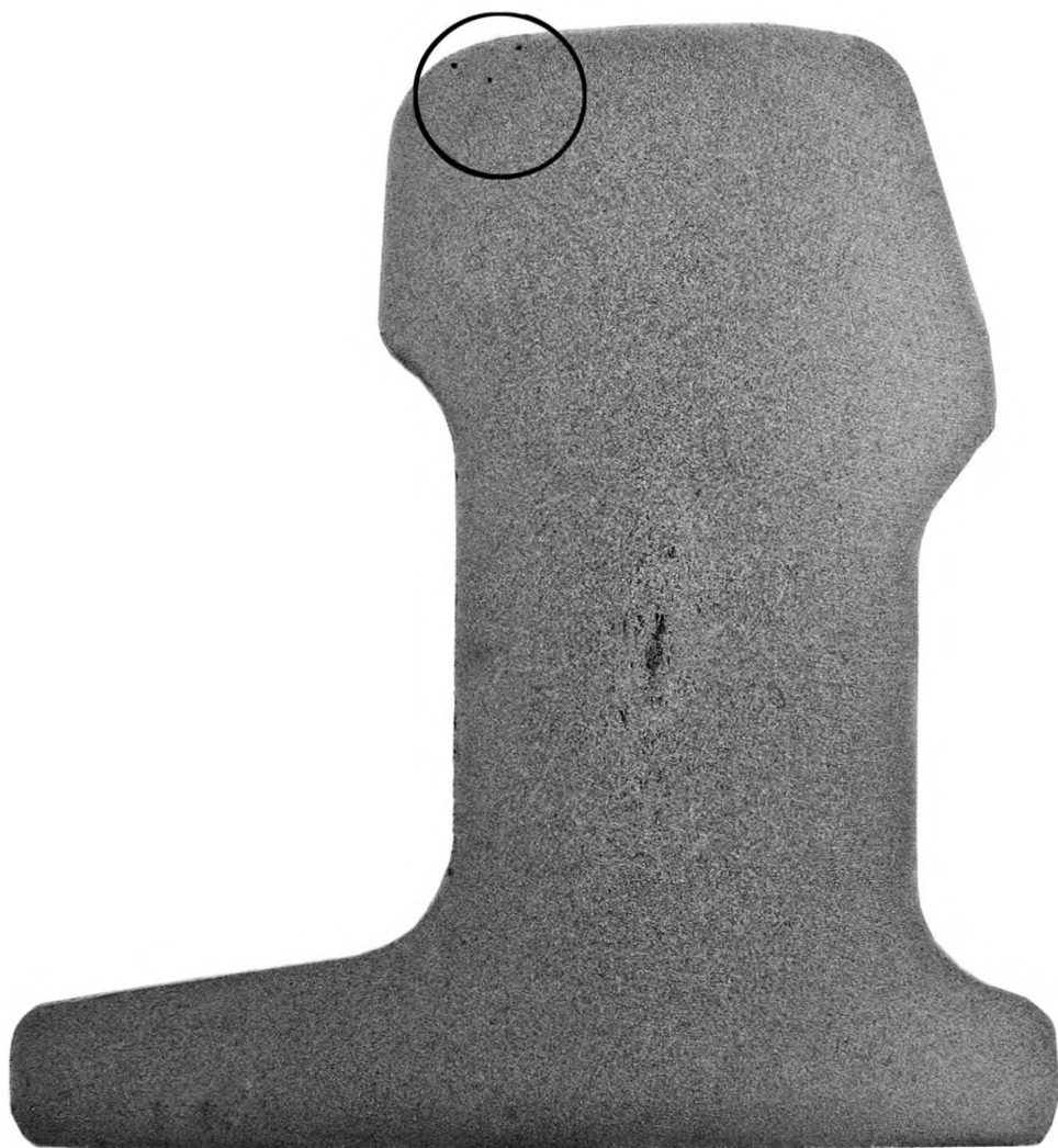
Рисунок Ж.4 — Точечная неоднородность в головке рельса
