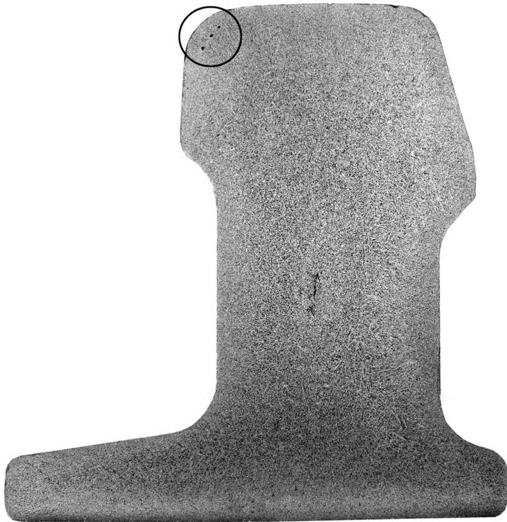
Рисунок Ж.7 — Точечная неоднородность в головке рельса
