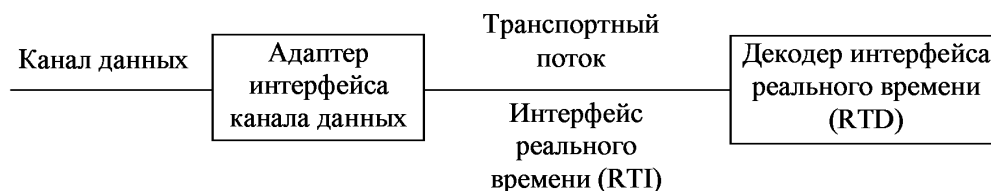
Р и с у н о к 1 – Схема интерфейса реального времени (RTI)
