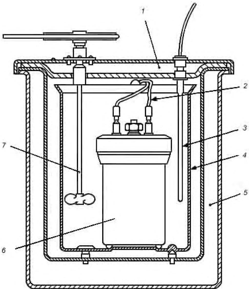
Обозначения: 1 — крышка термостата; 2 — контактные провода цепи зажигания; 3 — измеритель температуры; 4 — калориметрический сосуд; 5 — термостат; 6 — калориметрическая бомба; 7 — мешалка
