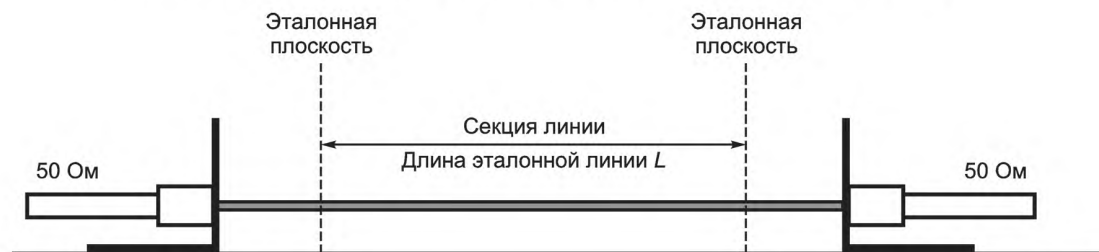
Рисунок 24д) — Конфигурация при калибровочном измерении «Линия»
