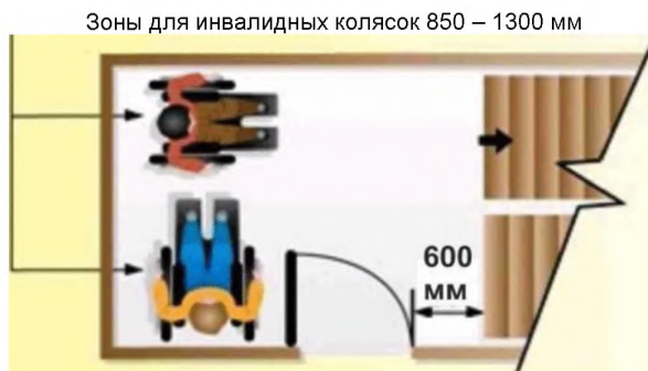
Рисунок 10 – Зона оказания помощи при эвакуации
