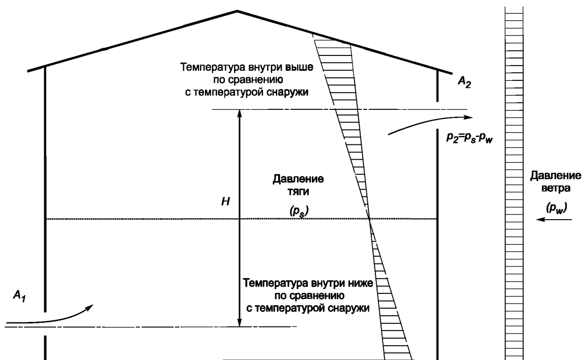
Рисунок С.1 — Пример противодействующих движущих сил вентиляционных потоков
