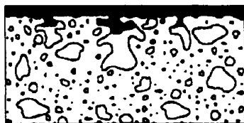
Рисунок 12 – Схема защиты цементобетона путем устройства сплошного защитного слоя
