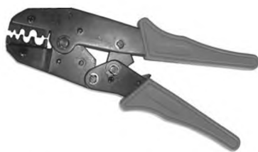
Рисунок А.6 – Пресс-клещи для опрессовки кабельных наконечников
