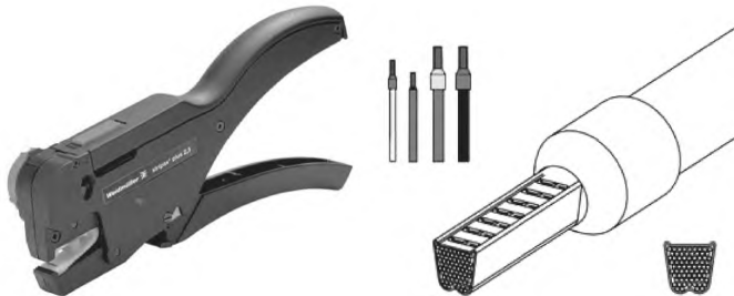
Рисунок А.10 – Инструмент для обжима кабельных наконечников
