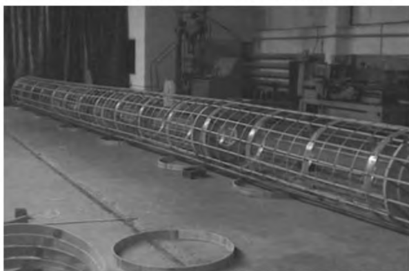
Рисунок 8.29 – Каркас буронабивной сваи из АНК-С в сборе
