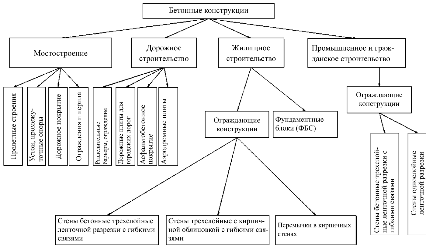
Рисунок 6.1 – Бетонные строительные конструкции, в которых возможно применение АНК
