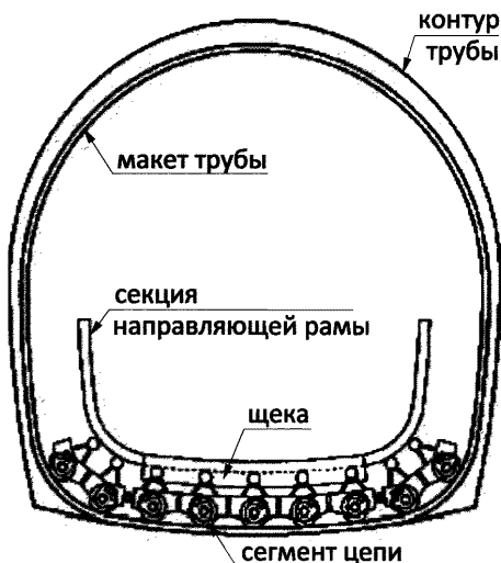
Рисунок 7 – Первый этап сборки навивочной машины
