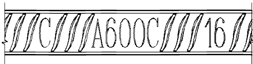
Рисунок 5.1 – Маркировка арматурного проката класса А600С
