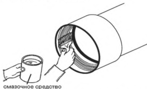
Рисунок Б.3 – Нанесение смазочного средства
