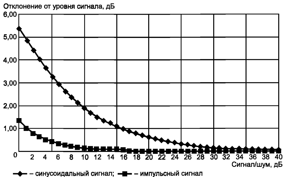
Рисунок А.1 — Отклонение показания уровня квазипикового детектора от уровня сигнала на входе приемника для двух случаев: синусоидальный сигнал и импульсный сигнал (частота следования 100 Гц)
