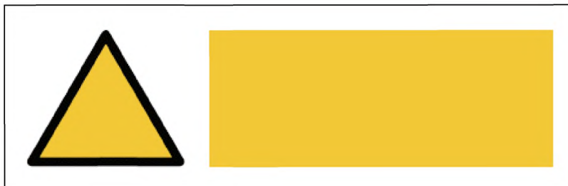
Рисунок 8 — Структура комбинированного знака: дополнительный знак расположен ниже знака безопасности
