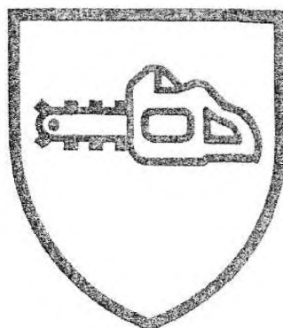
Рисунок 2 – Пиктограмма, указывающая на защиту от разрезания цепной пилой
