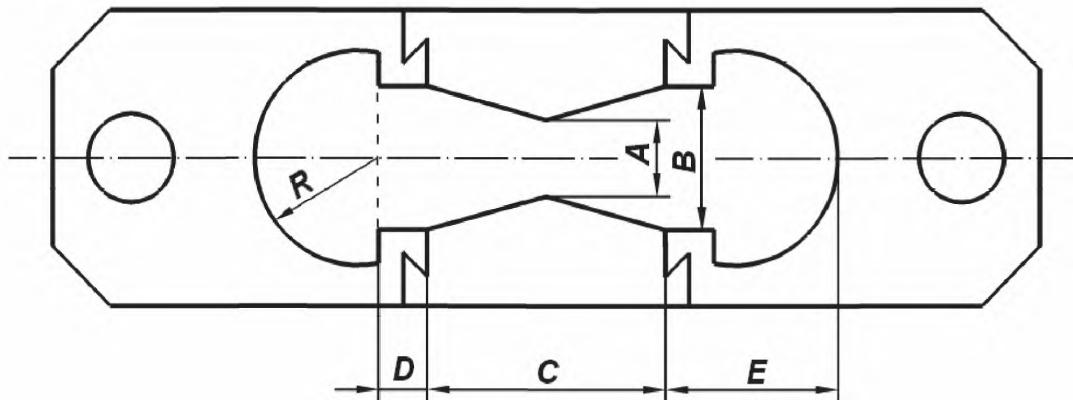
$A = (10,0 \pm 0,2)$  мм;  $B = (20,0 \pm 0,2)$  мм;  $C = (30,0 \pm 0,3)$  мм;  $D = (7,3 \pm 0,5)$  мм;
