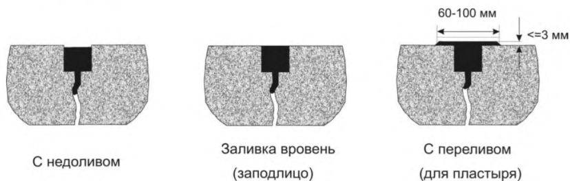
Рисунок 1 – Варианты заливки герметика в трещины
