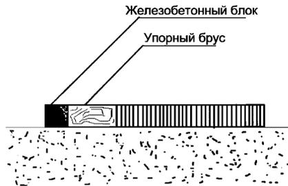
Рисунок 9.2 – Установка бруса по окончании работ
