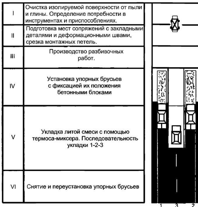
Рисунок 9.1 – Технологическая схема устройства гидроизоляционного покрытия из литой асфальтобетонной смеси
