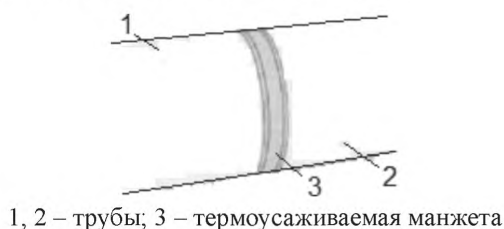
Рисунок 9.21 – Фрагмент трубопровода, собранного из ТПСС с использованием винтовых выступов и термоусаживаемой манжеты
