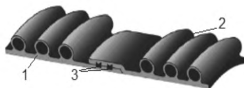
Рисунок 7.7 – Соединение труб спиральновитых из полового с фигурным поперечным сечением профиля
