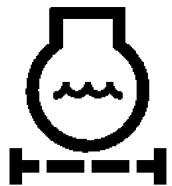
(A bulbous container icon with a small horizontal line and a vertical line below it, representing a filter) | Фильтр охлаждающей жидкости в двигателе                                                                            | ISO 7000—1562                    |
