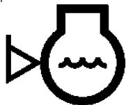
(A bulbous container icon with a downward-pointing arrow below it)                                          | Уровень охлаждающей жидкости в двигателе                                                                           | ISO 7000—1378                    |
