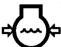
(A bulbous container icon with two arrows pointing outwards from the sides, representing pressure)          | Давление охлаждающей жидкости                                                                                      | ISO 7000—1379                    |
