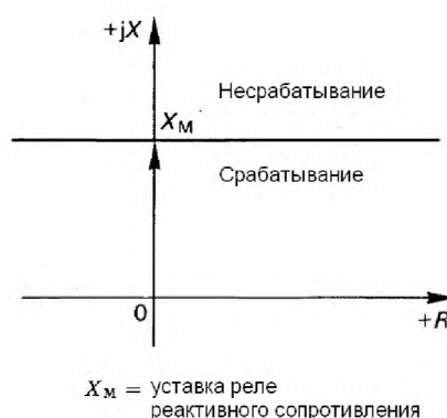
Рисунок 1б — Характеристика реактивного сопротивления
