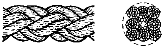
Рисунок 3- Конфигурация 8-рядного плетеного каната (тип L)
