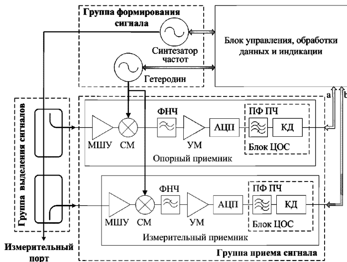
Рисунок А.1 – Структурная схема ВАЦ (рефлектометра)
