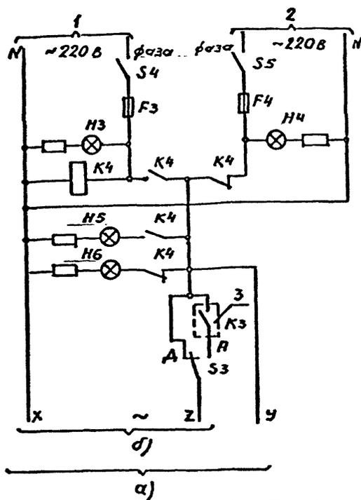
Рис. 12.7. Принципиальная схема питания сети управления переменным током.
