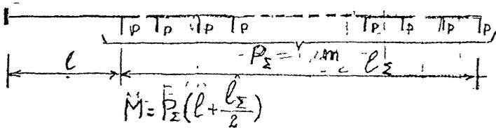
Равномерно распределенная и одна или несколько сосредоточенных нагрузок
