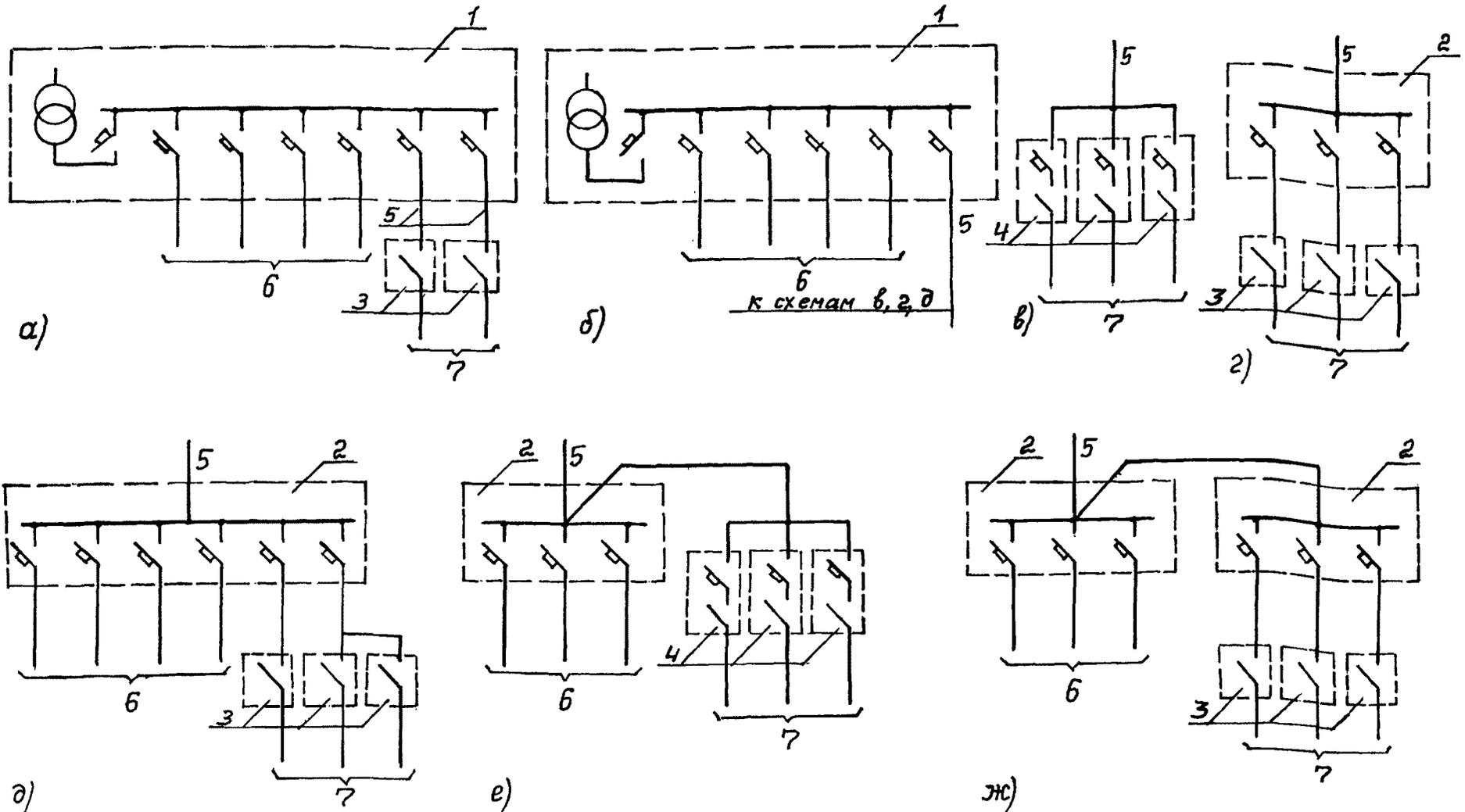
Рис.10.3. Схемы питания НО при дистанционном или телемеханическом управлении с магнитными пускателями в линиях распределительной сети.
