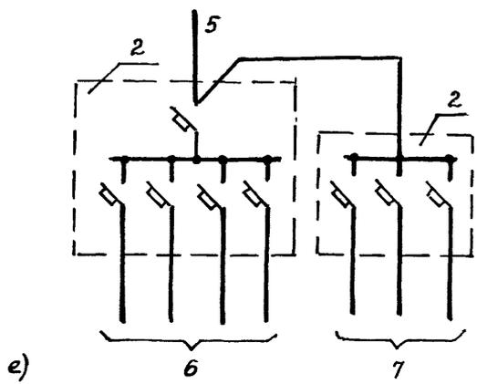
Рис.10.1. Схемы питания НО при отсутствии пиланционного и телемеханического управления.
