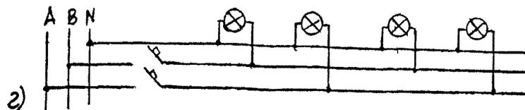
Рис.10.4. Схемы линий распределительной сети. а,б,в,г,д - при питании ОП фазным напряжением 220 В; е,ж - при питании ОП линейным напряжением 380 В.
