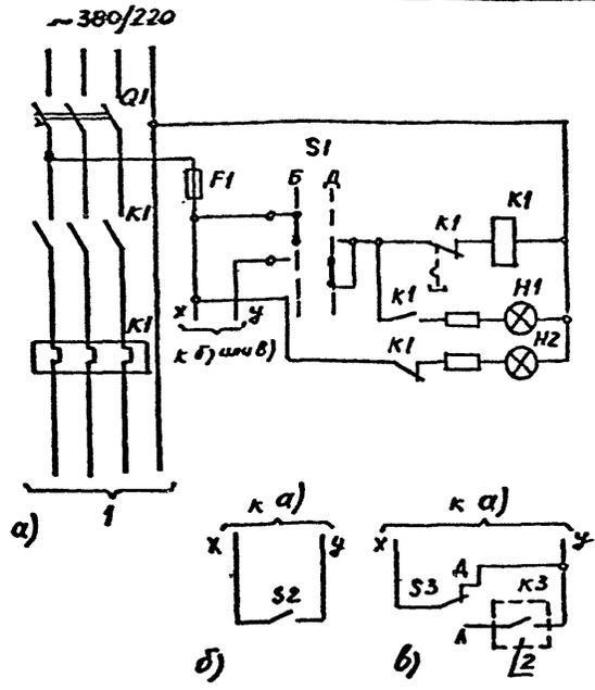
Рис. 12.2. Принципиальная схема дистанционного, фотоавтоматического и программного управления освещением по контрольным кабелям без промежуточных реле.
