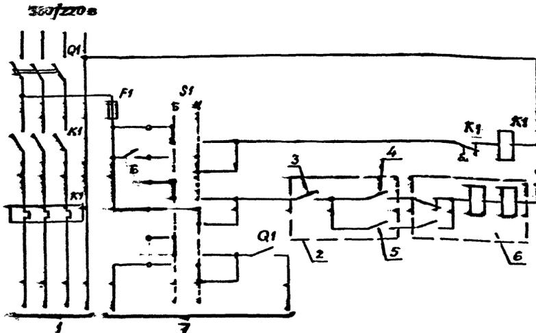
Рис. 124. Принципиальная схема телемеханического управления двигателем.
