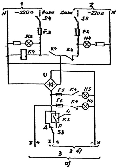
Рис. 12.6. Принципиальная схема питания сети управления постоянным током от выпрямителя.
