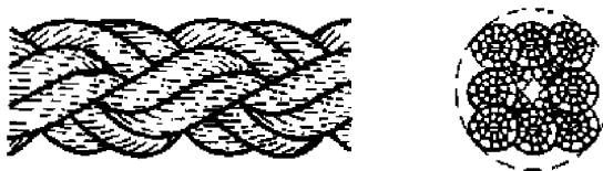
Рисунок 3- Конфигурация 8-рядного плетеного каната (тип L)
