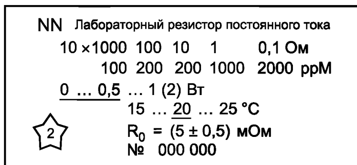
Рисунок 3 — Пример маркировки пятидекадного резистора
