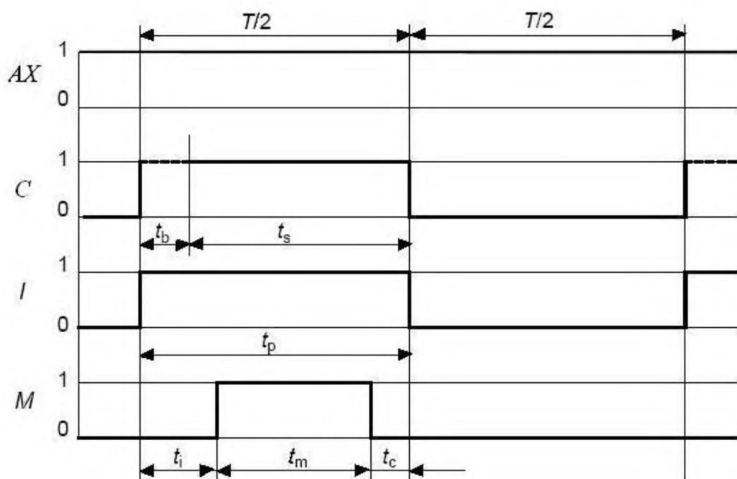
$C$  — испытуемый контакт;  $I$  — испытательный ток;  $M$  — измерение падения напряжения или контроль нагрузки;
