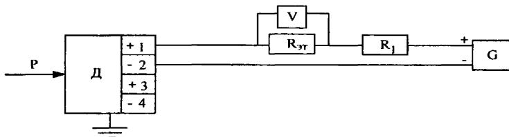
$V$  – цифровой вольтметр или компаратор напряжения постоянного тока, указанные, например, в табл.1;
