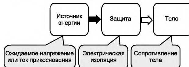
Рисунок 4 — Модель защиты от боли или травм, вызываемых воздействием электричества
