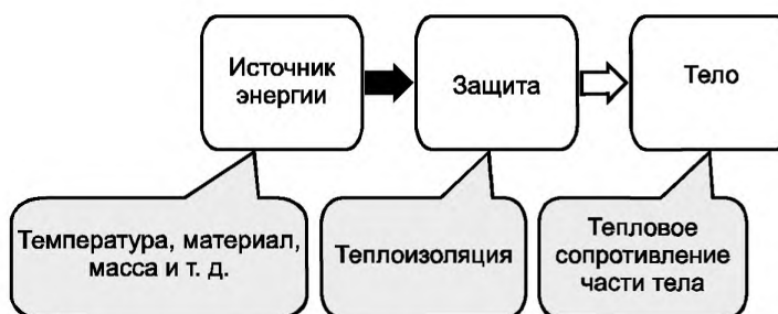
Рисунок 8 — Схема и модель защиты от тепловых травм
