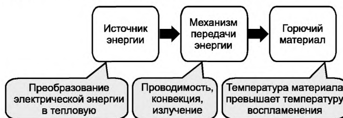
Рисунок 5 — Модель возникновения возгорания при воздействии электричества
