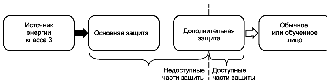
Рисунок 21 — Изображение доступных и недоступных частей дополнительной защиты
