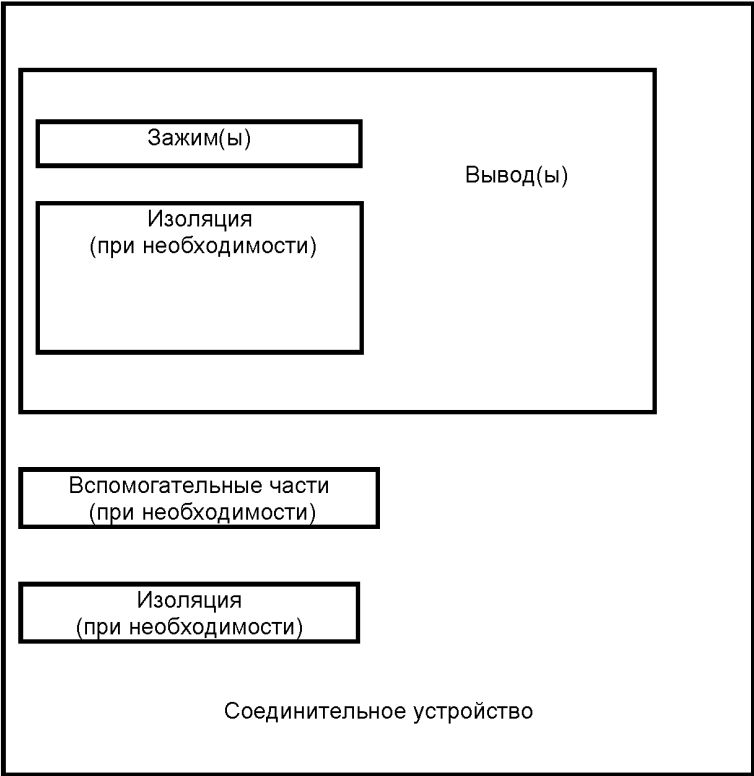
Рисунок D.8 – Зажим в соединительном устройстве
