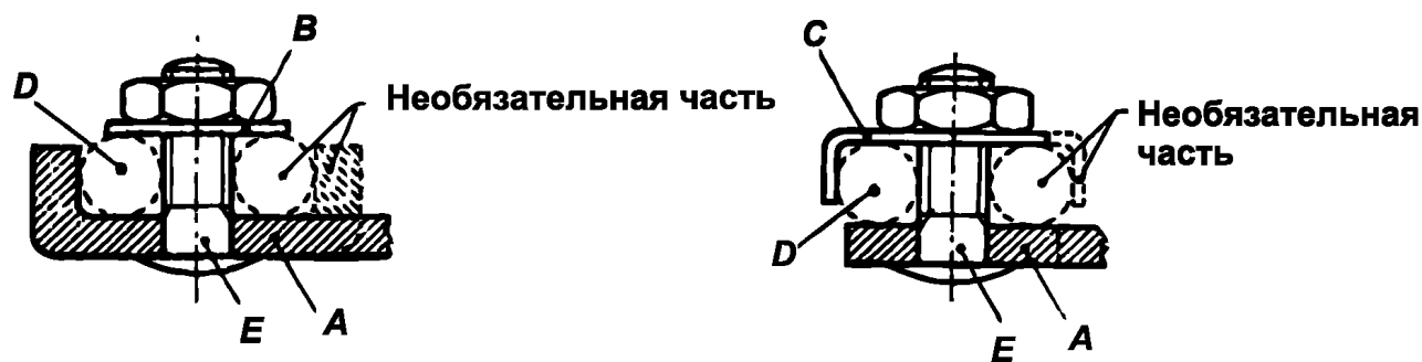
A – неподвижная часть; B – шайба или прокладка; C – антиразжимное устройство; D – место для проводника; E - штифт
